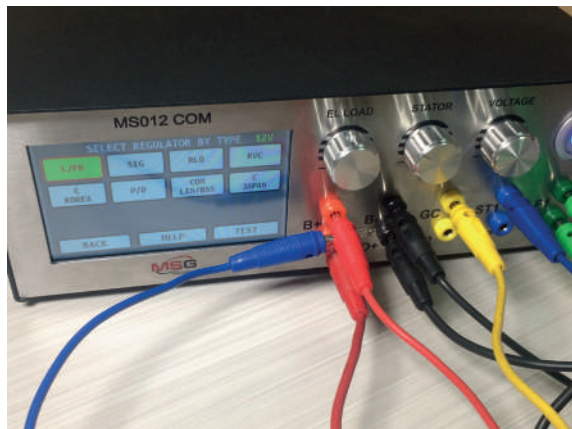
Рисунок 19. Подключение дополнительного провода В+
